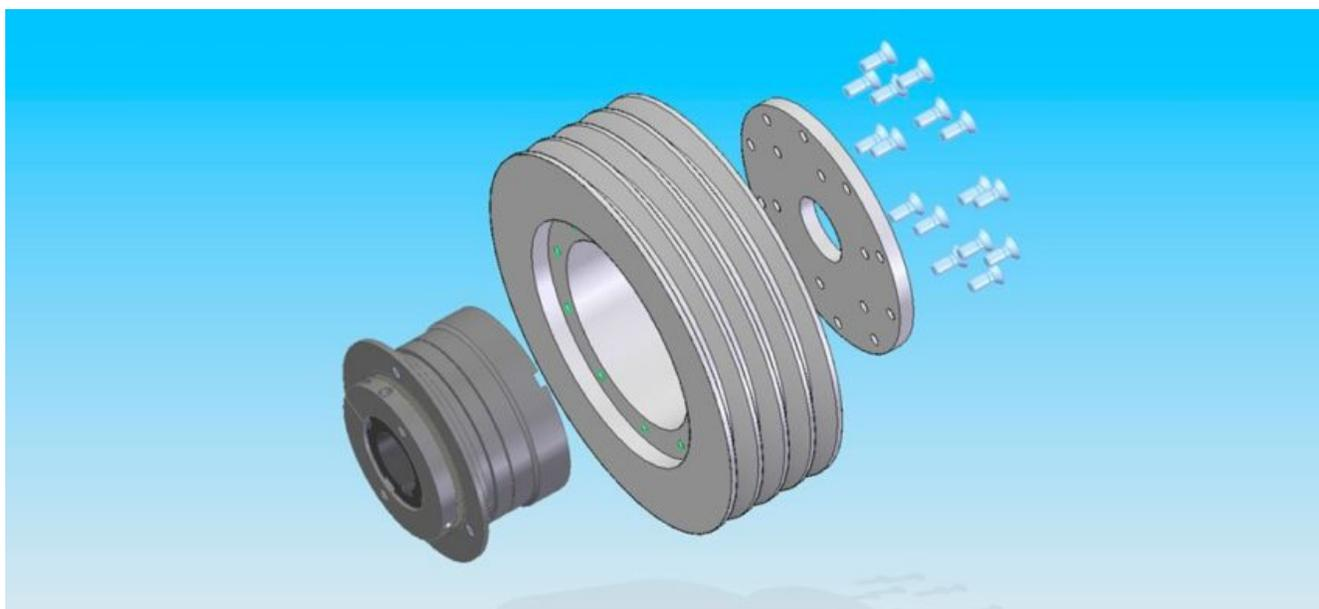
Dispositivo limitatore di coppia per macchine trinciatrici applicato al rotore. Il posizionamento determina una immediata interruzione del moto, preservando tutti gli altri organi meccanici (cinghia, riduttore, cardano, ecc.).
