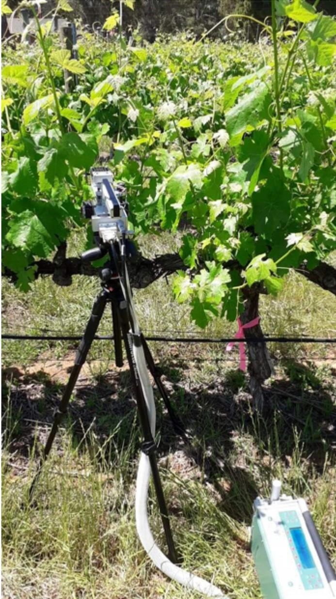
Analizzatore di gas a infrarosso
