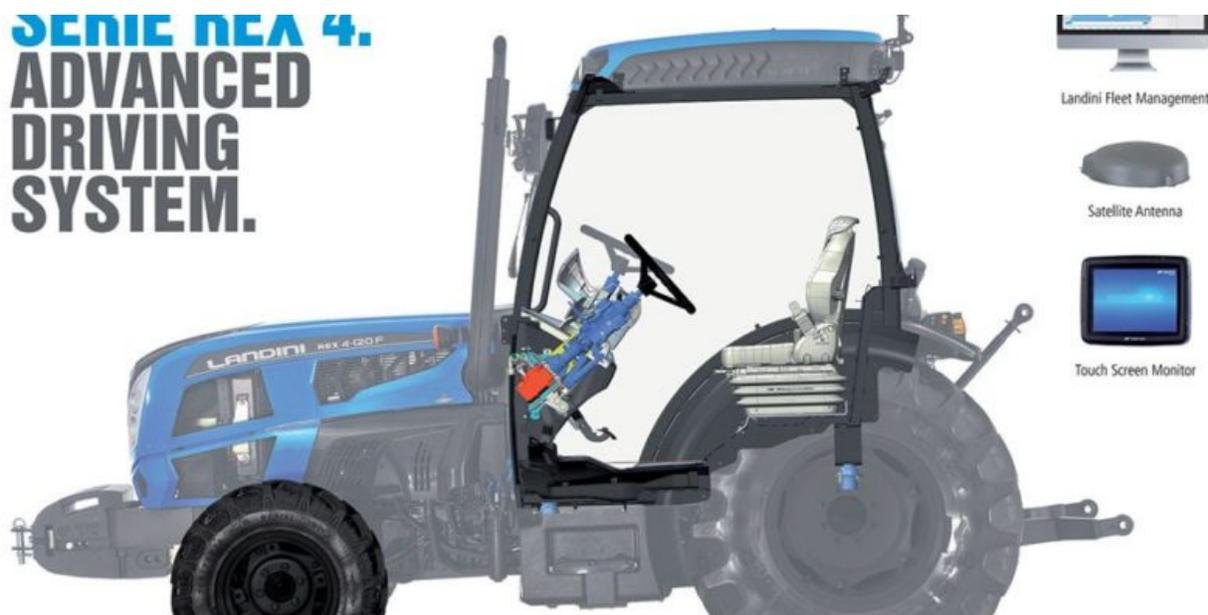
Trattrice per frutteto dotata di sistemi di: agevolazione alla guida, comandi ottimizzati, moduli per lo scambio dati e sistema di localizzazione GPS. L'insieme di queste soluzioni, abitualmente riservate a gamme di trattori da pieno campo, riduce l'affaticamento dell'operatore, che può concentrarsi sulla gestione delle attrezzature, e aumenta la sicurezza nella guida, in particolare nelle operazioni di trasferimento a velocità più elevate.
