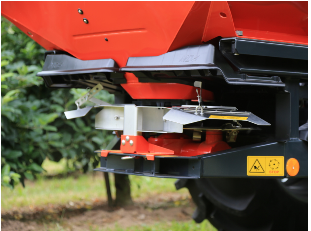
Dettaglio del deflettore di spargimento su 2 file
