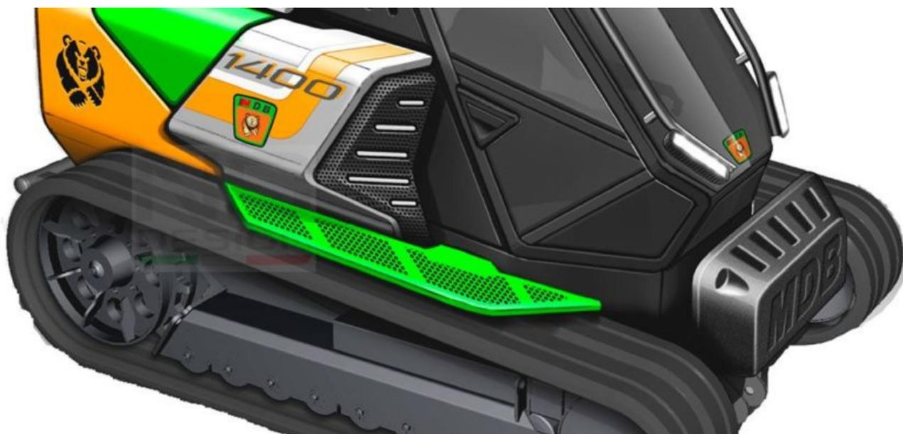
Macchina cingolata controllata con radiocomando e dotata di cabina elevabile per l'operatore; la macchina può montare una trinciatrice in posizione frontale e, con la cabina in posizione elevata, un braccio laterale portattrezzi in posizione ventrale. La realizzazione riunisce soluzioni tecniche diverse per aumentare la modularità, la polifunzionalità e il comfort dell'operatore.
