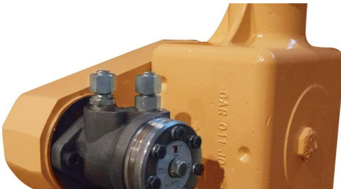
Dispositivo di avviamento idraulico alimentato dalle prese della trattrice per attrezzature a elevata inerzia, come trinciatrici di grandi dimensioni. La soluzione permette di salvaguardare l'integrità meccanica della trattrice in applicazioni gravose.
