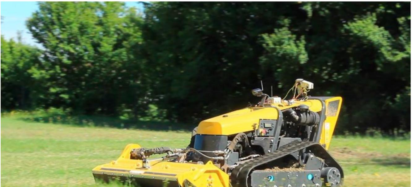
Sistema di guida automatica capace di guida parallela per robot trinciaerba, basato su tecnologia D-GPS. Il costo del dispositivo di posizionamento è stato contenuto in modo da renderlo effettivamente fruibile sul mercato di questa tipologia di macchine.
