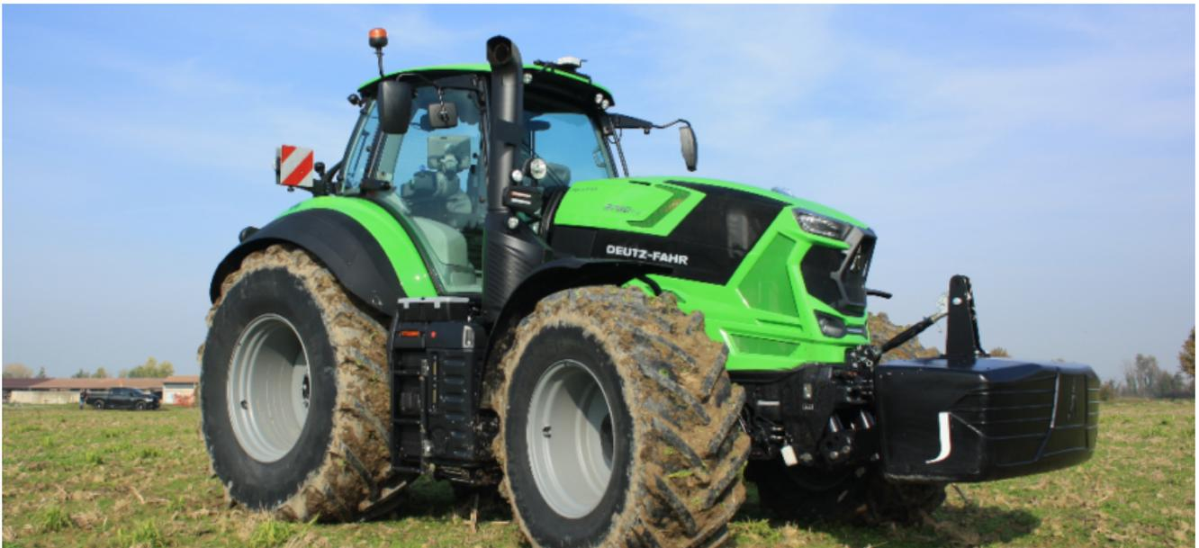
**Zavorrare il trattore** è un metodo molto diffuso, economico e pratico per incrementare la capacità di trazione e la stabilità.
