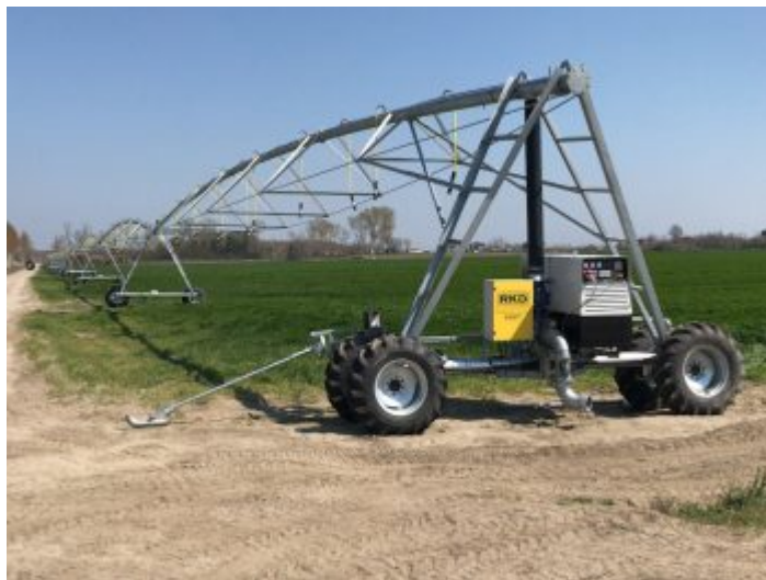
2-Impianto irriguo a movimento lineare o rainger
