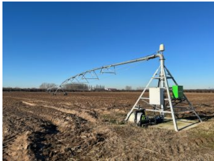
1- Impianto irriguo a perno centrale o pivot
