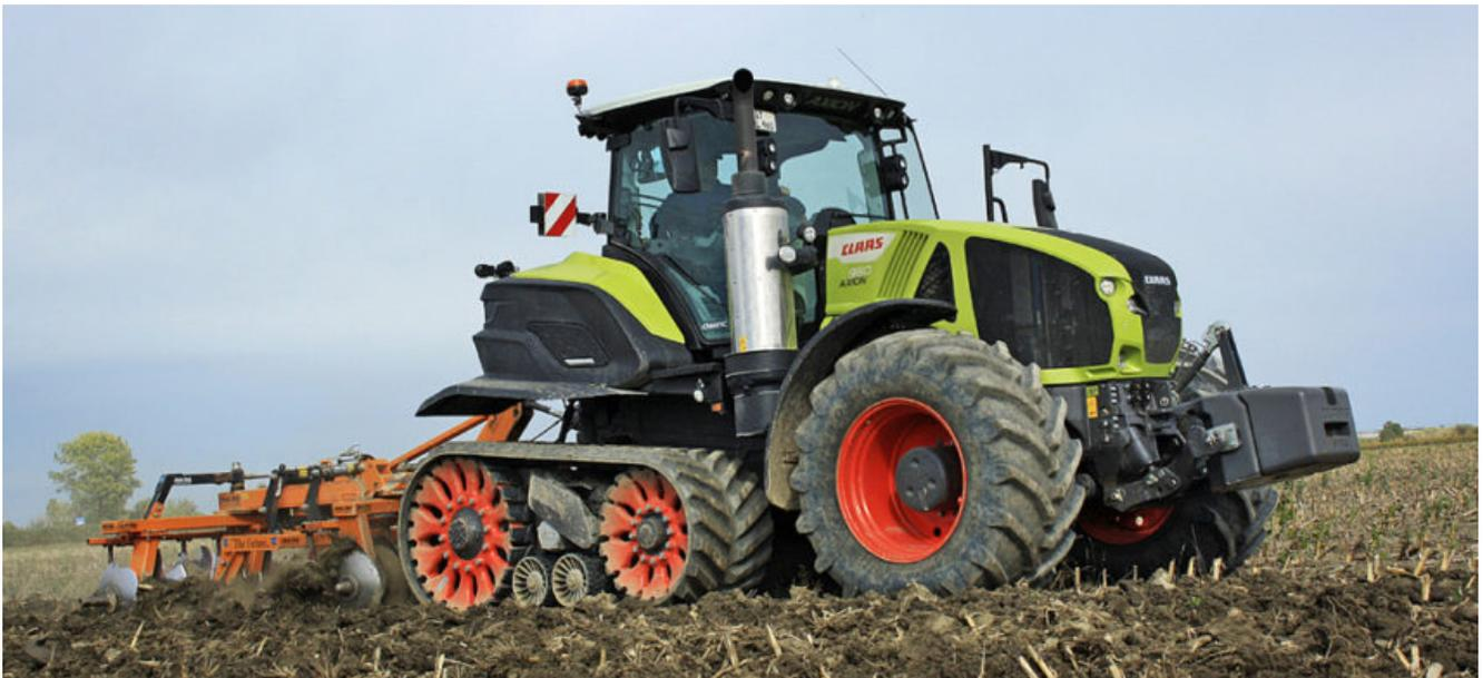
All'interno della serie dei trattori gommati d'alta potenza Axion, **Claas** propone due modelli, il 930 da 350 CV e il **960 da 440 CV**, in versione **Terra Trac semicingolata** dove, al posto dei tradizionali pneumatici posteriori, è applicato un **sistema di cingolatura con cinematismo brevettato**.
