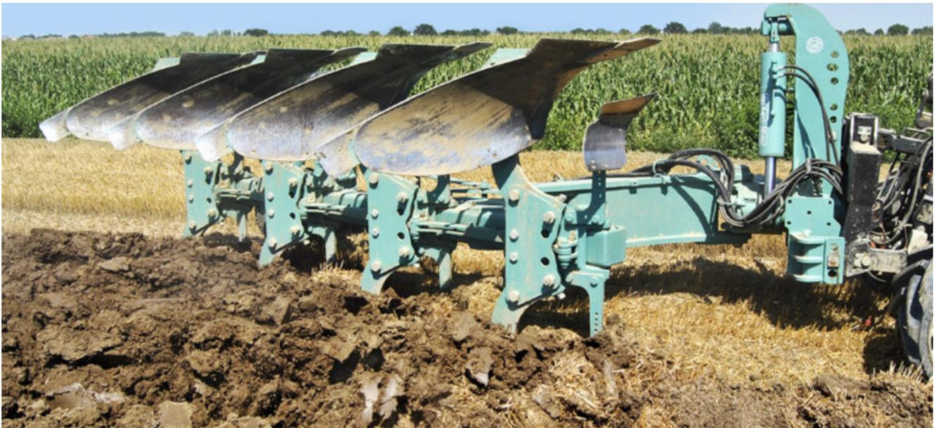
Gli elementi cui prestare maggior attenzione per il mantenimento in efficienza degli aratri sono rappresentati da: dispositivi di collegamento, telaio e sistemi articolati di regolazione e posizionamento, sistema idraulico di asservimento ed elementi di lavoro.
