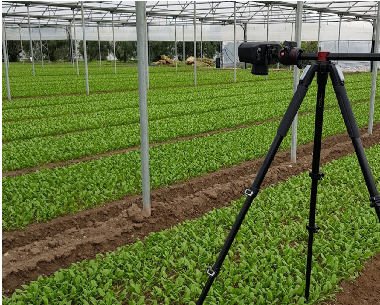
Camera iperspettrale per la valutazione della qualità del suolo e del contenuto di sostanze
