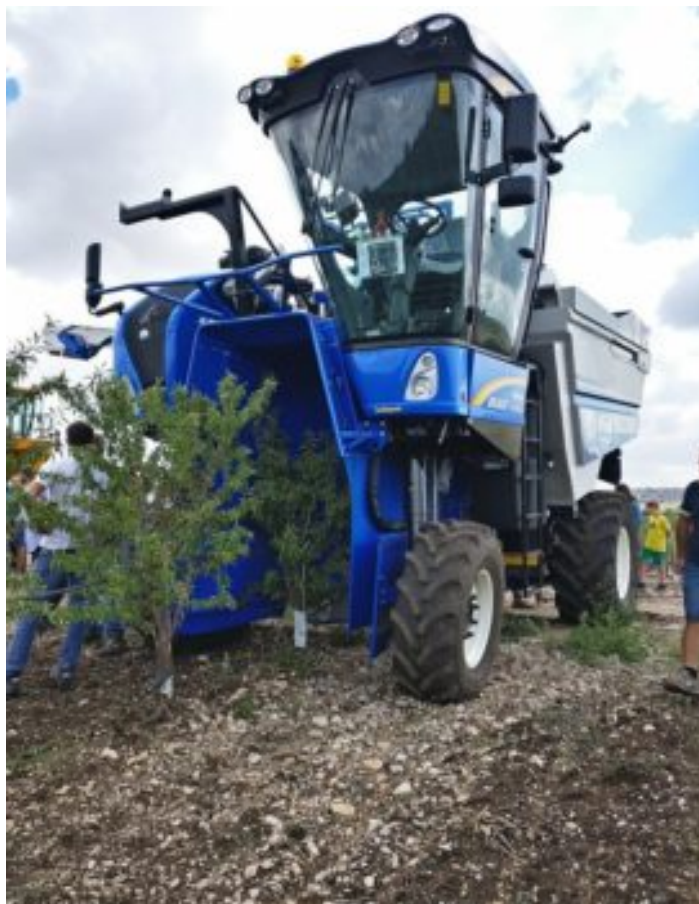
Scavallatrice per la raccolta in continuo dei mandorleti superintensivi.
