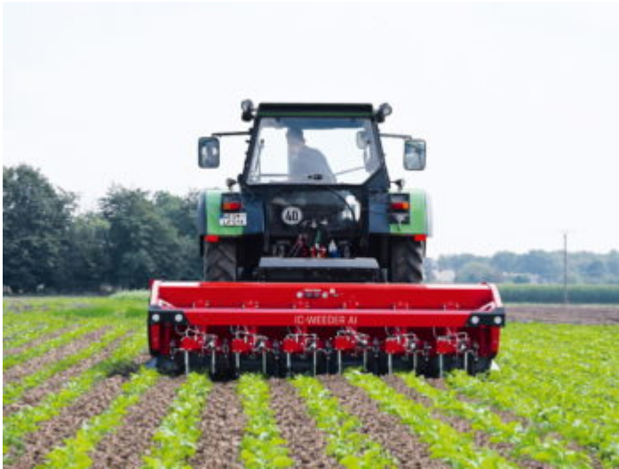
La zappatrice IC-Weeder AI di Lemken con riconoscimento automatico delle piante
