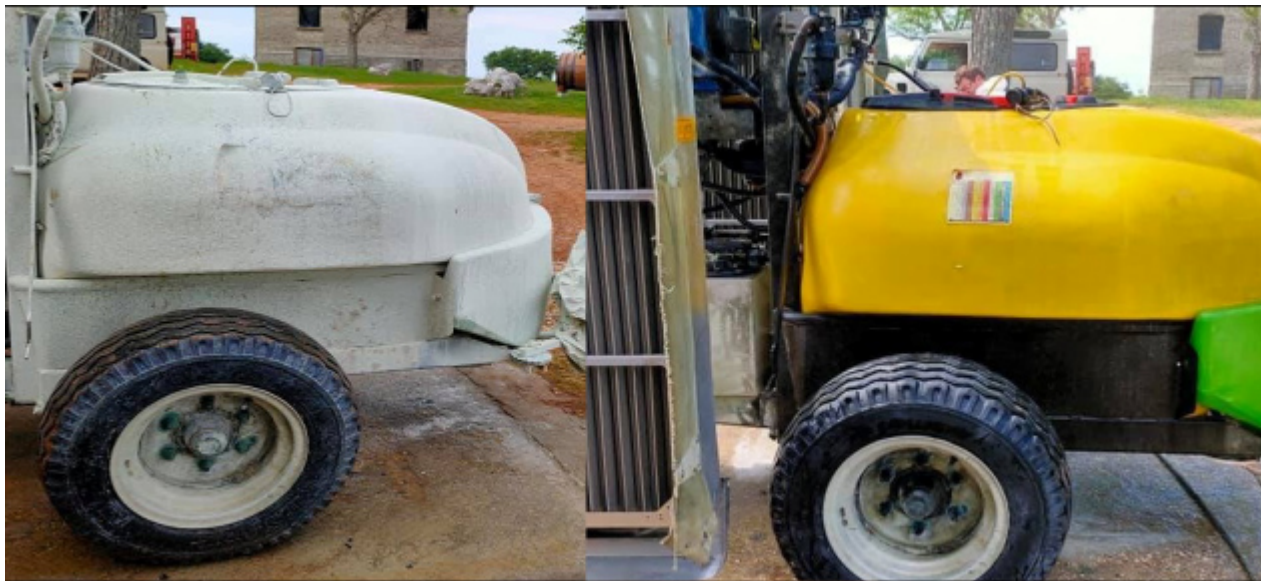
Atomizzatore prima e dopo la pulizia
